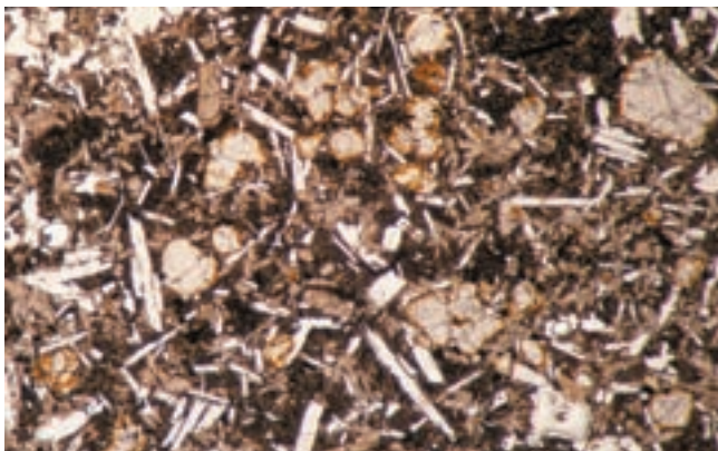
写真 10a : ハラビア・ゼノビアの玄武岩 (試料番号 : 071114 - 5) 薄片の偏光顕微鏡写真。 解放ニコル。写真横幅は約 4 mm。
